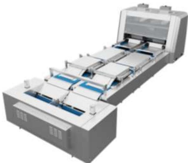
Промышленные тестозакатывающие машины предназначены для придания окончательной формы заготовкам из теста. В процессе движения по конвейеру, заготовка принимает цилиндрическую форму. Прессовочная подушка легко настраивается для получения выпуклой или плоской поверхности изделия. Система централизации направляет тесто строго по центру, что гарантирует правильную и симметричную форму. Машина оборудована системой присыпки мукой. Наличие колесиков позволяет легко перемещать оборудование.
