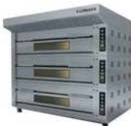
Подовая модульная печь EF2050 (2 яруса – электрическая)
